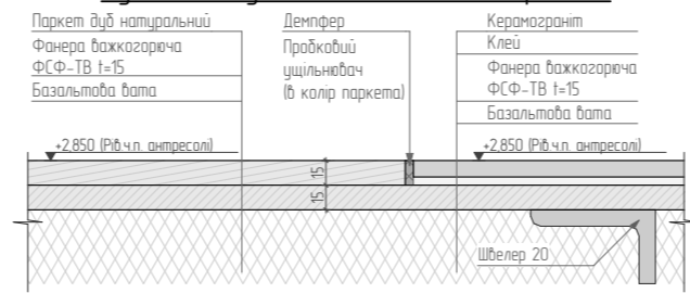
Вузол стикування підлогових покриттів
